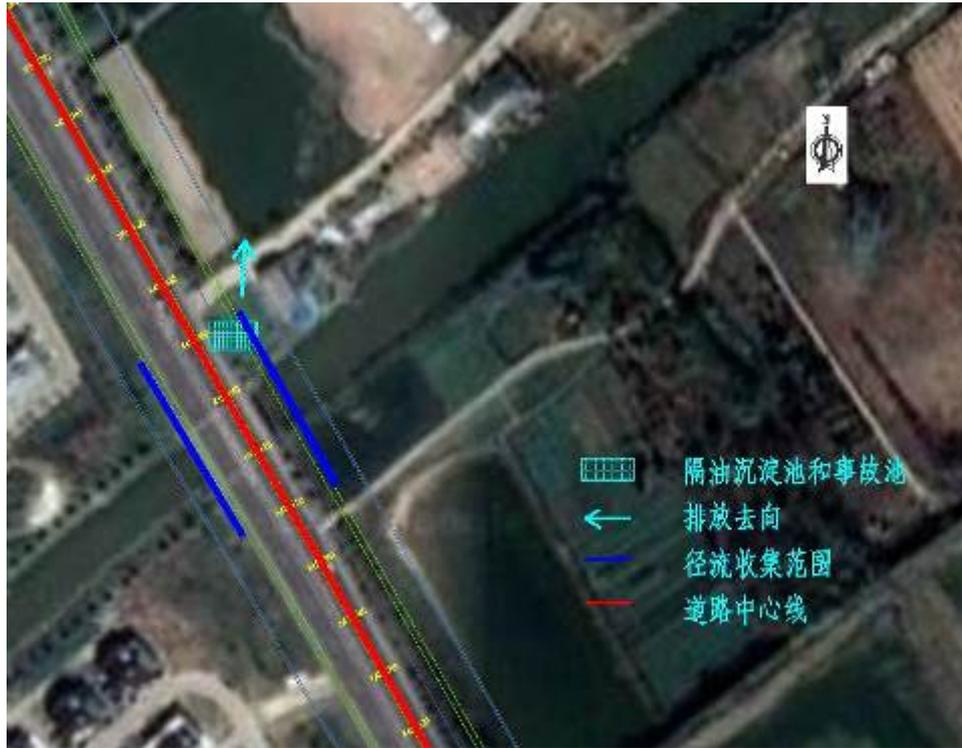
图 8.3-1 翻身河中桥桥面径流收集示意图
