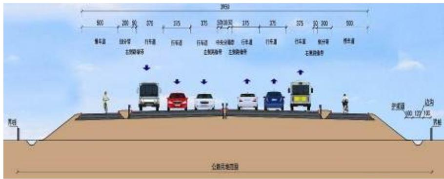
图 2.3-3 现状 204 国道断面（上网镇区、沟墩镇区段）
