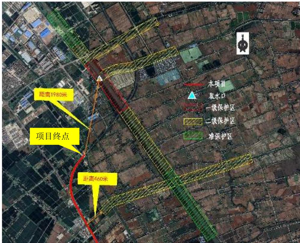
图 4.2-1 本项目与城东水厂取水口水源地位置关系图
